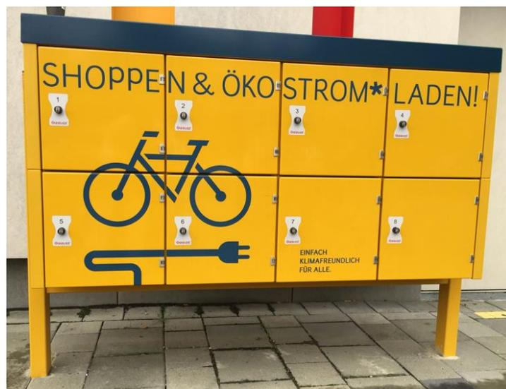
Abbildung 80: Beispiel für Fahrradschließfächer zum Laden von Pedelecs (eigene Darstellung, VAR+, 2021)
