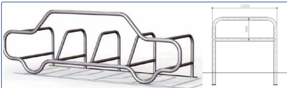
Abbildung 77: Links: Reihenanlage für 10 Fahrräder; rechts, Anlehnbügel mit Querholm bemaßt (Quelle unbekannt, o. J.)
