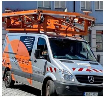
Das „eagle-eye“ dokumentiert den Straßenzustand. Foto: privat
