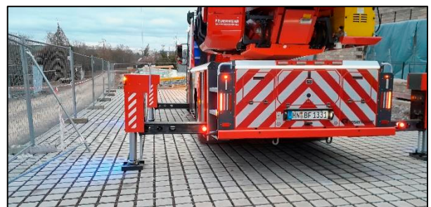
Feuerwehraufstellfläche am Geh- und Radweg
